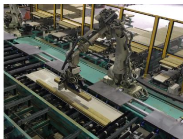
パネル芯材をロボットで自動供給
