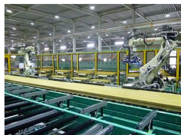
パネル芯材をロボットで自動供給
