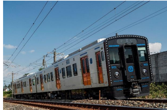
YC1系蓄電池搭載型ディーゼルエレクトリック車両
