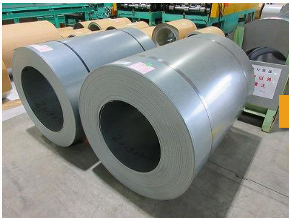
① 素材：コイル鋼材（薄板）
