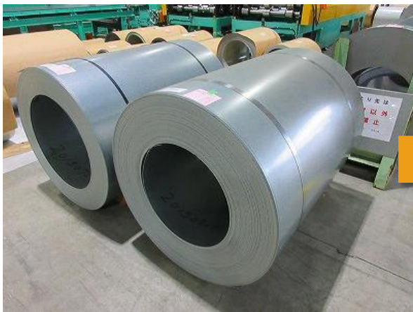
① 素材：コイル鋼材（薄板）
