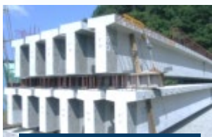
プレキャスト桁橋
