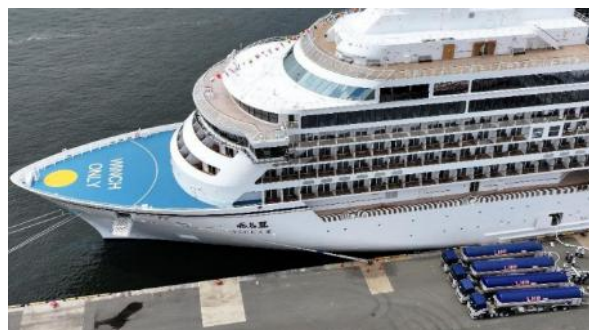
Truck to Ship方式による LNGバンカリング
