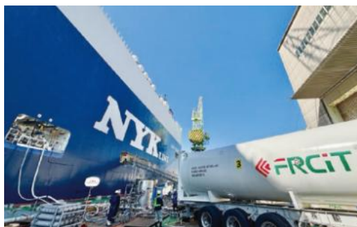
ISOタンクコンテナによる LNGバンカリング
