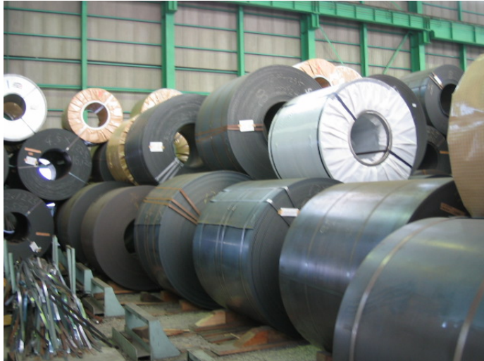
鋼板の材料となる熱延コイル
