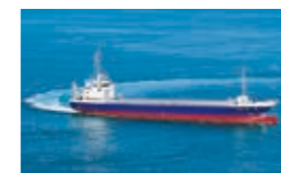
リチウムイオン電池搭載型ハイブリッド貨物船「うたしま」
